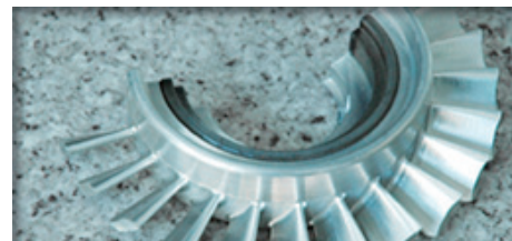
③同時5軸加工機による精密加工事例
