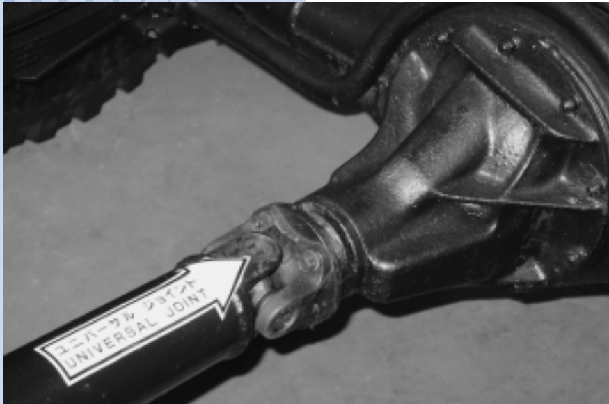
同社が製造している自動車の「ユニバーサルジョイント」部分
