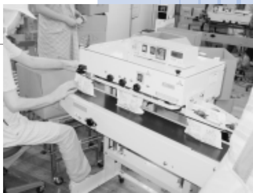
金属探知機で製品に異物が混入していないかを検査
