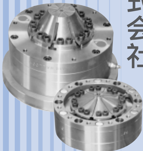
空気圧による膜弾性変型を利用したエアバルーンチャック
