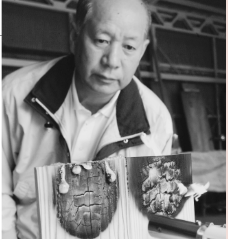
燃焼実験：向かって左が不燃処理、右が未処理の板 不燃処理を行えば炭化するものの、決して燃え上がることはない
