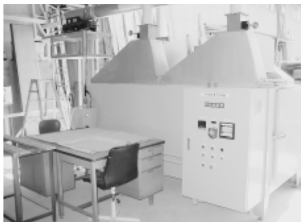
乾燥機： 木材の含水率をコントロールし、注入に適した状態に整え、注入後の余剰な水分を飛ばす
