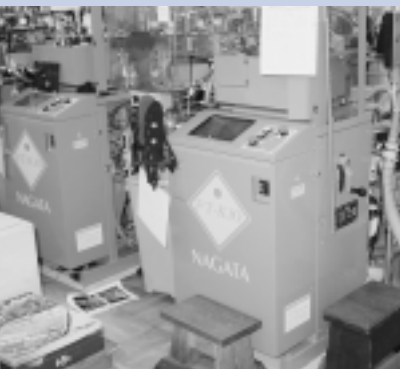
新たに導入した自動リンク装置付靴下編機 作業工程軽減・リードタイム短縮に貢献。
