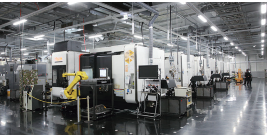
独自の自動搬送システムによる無人化工場
