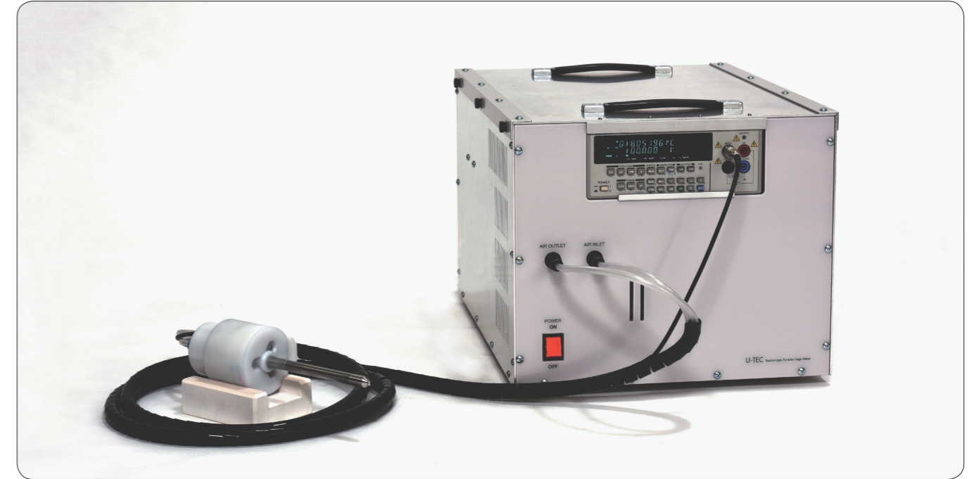
プローブ (左) と気中電荷量測定装置本体 (右)
