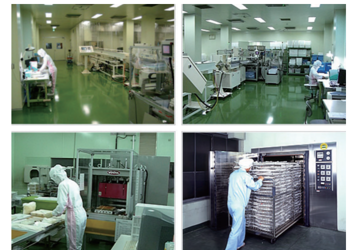
医療用ゴム製品製造工場のクリーンルーム
