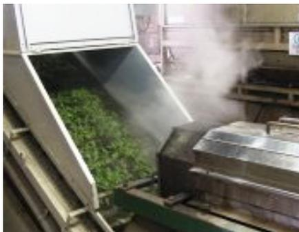
写真1 網胴回転攪拌式蒸機
